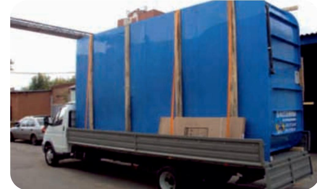
Во избежание повреждения чаши бассейна во время перевозки, нужно очень ответственно подойти к вопросу ее раскрепления в грузовике. Чаша должна быть притянута транспортными ремнями (в крайнем случае использовать проволоку), те места, где возможно образование потертостей, должны быть проложены паролоном, люфт свободного хода должен быть выбран с помощью деревянных сухарей.
